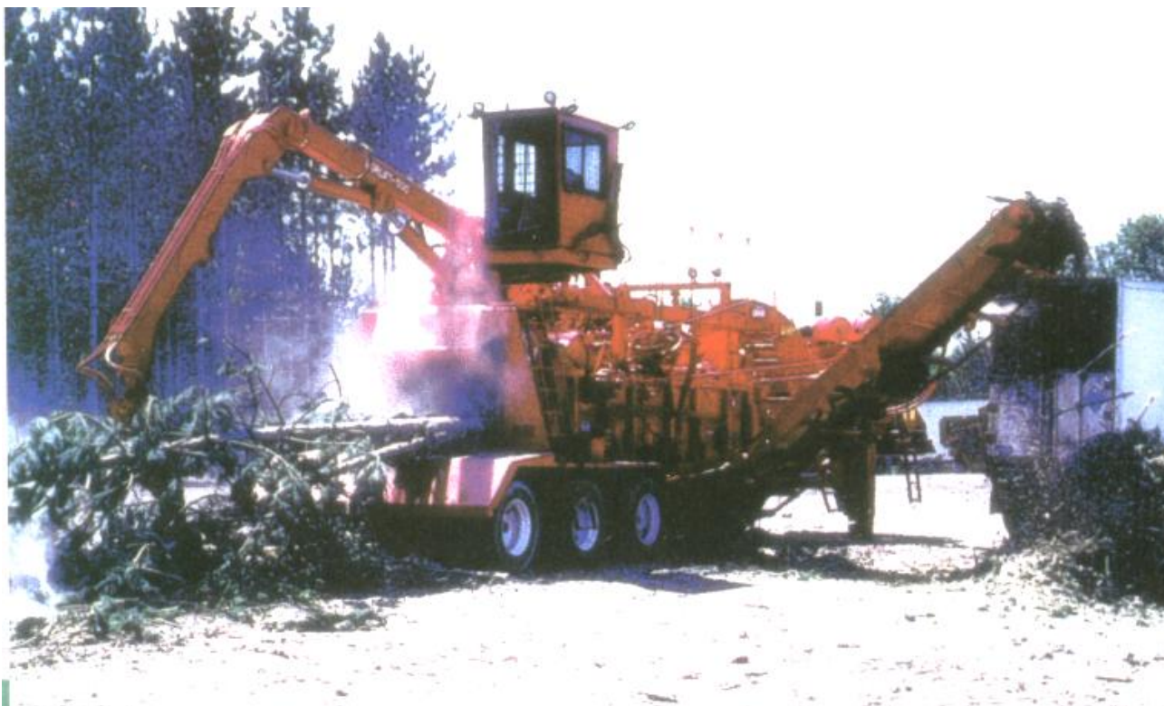
Рис. 3. Сучкорезно-окорочно-рубительный агрегат фирмы Morbark Industries.Ink, США
