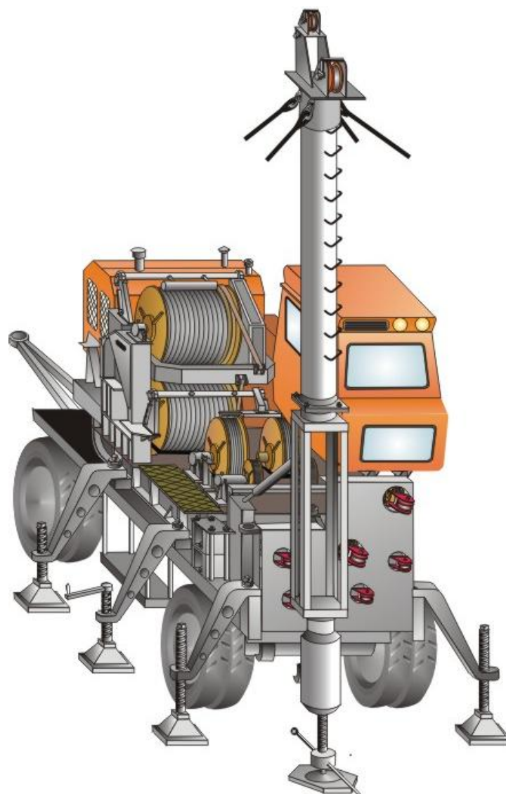
Рисунок 7 – Вариант лебедочной установки с инвентарной мачтой
