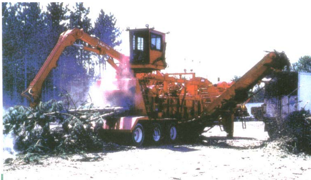
Рисунок 2 – Сучкорезно-окорочно-рубительный агрегат фирмы Morbark Industries.Ink, США
